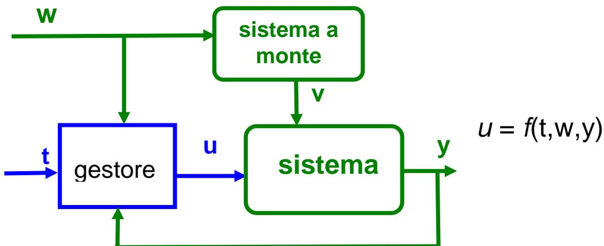
**Sistema complesso** (nei casi complessi, es. gestione di un serbatoio, il gestore misura gli ingressi  $v$  (portate), gli ingressi  $w$  (piogge), le uscite  $y$  (livelli), il tempo  $t$  e può essere dinamico).
