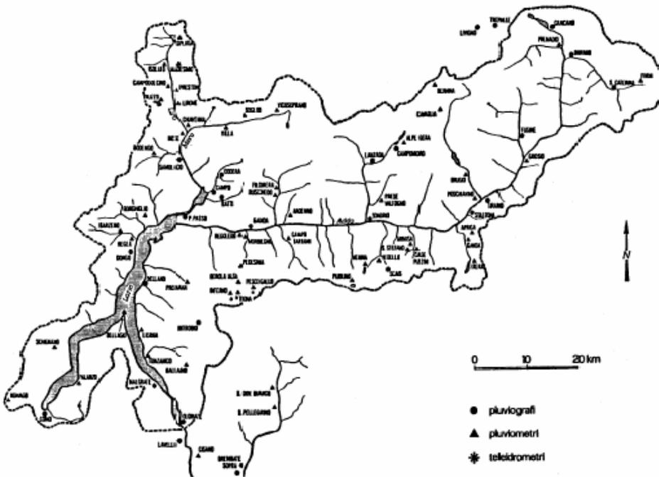
Fig.10 - Stazioni idrometriche e pluviometriche nel bacino dell'Adda.
