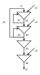
Si formuli un modello che rappresenti il funzionamento del sistema idrico rappresentato in figura, dove i parametri  $a_1$ ,  $a_2$  e b rappresentano percentuali delle quantità di acqua uscenti transitanti nei rispettivi tronchi.
